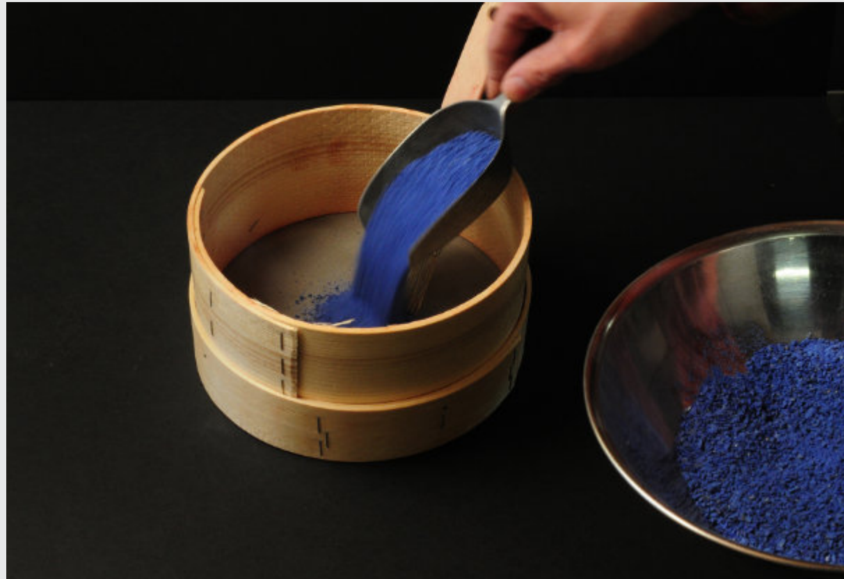
Bestimmung der Korngröße mittels Sieb; Foto: © Kremer Pigmente
