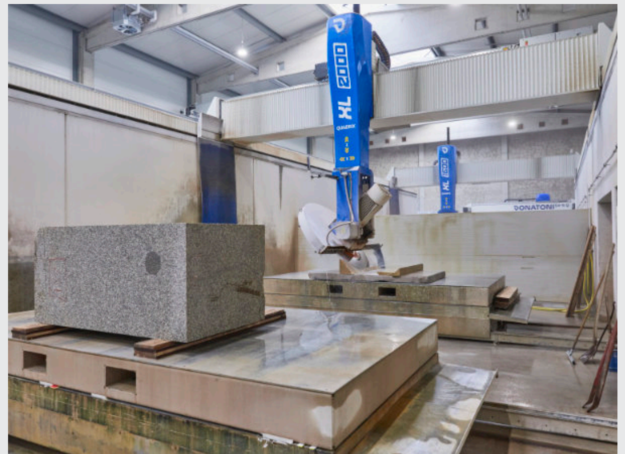
Neue CNC-Brückensäge im Werk des Bamberger Natursteinwerks; Foto: © Richard Watzke
