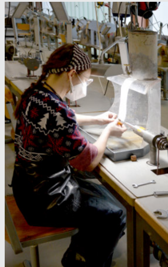
Edelsteinbearbeitung an der Gravierspindel; Foto: © Gina Müller
